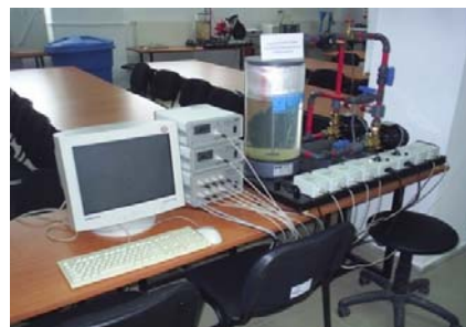
Instalatie pentru studiul functionarii pompeilor cuplate in serie si paralel
