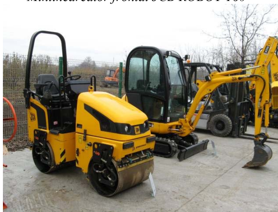
Cilindru vibrocompactor JCB VIBROMAX 160
