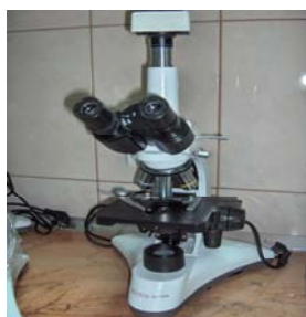
Microscop Mikros cu cameră digitală pentru achiziție și prelucrare imagine
