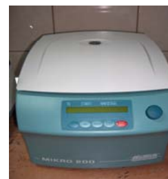
Centrifugă Eppendorf 15.000 rpm
