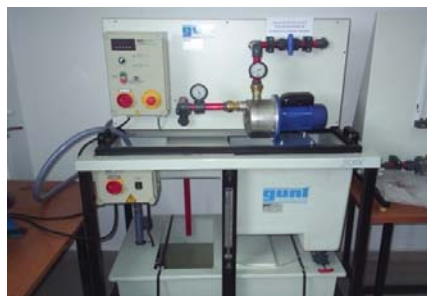
Instalatie pentru studiul functionarii pompeilor actionate la turatie variabile
