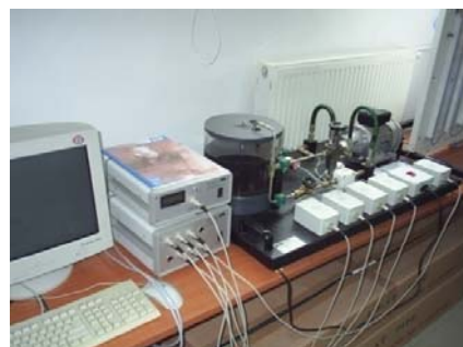
Instalatie pentru studiul functionarii pompeilor volumice cu roti dintate
