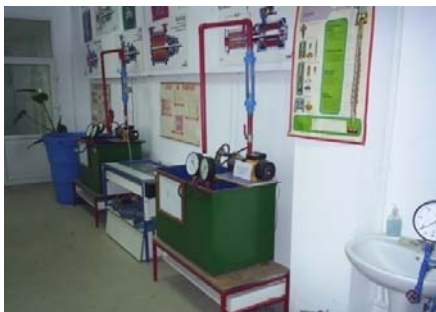
Instalatie pentru studiul functionarii pompeilor centrifuge cu ax orizontal
