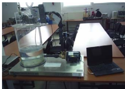
Instalatie pentru studiul functionarii turbinelor Pelton
