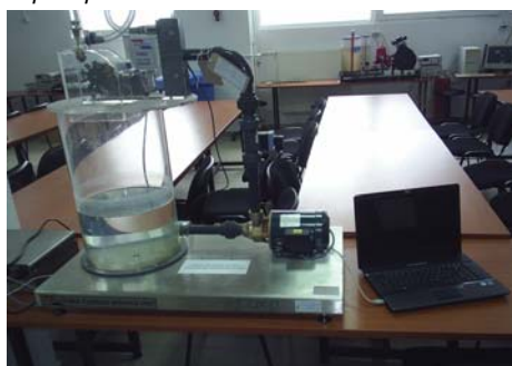
Instalație pentru studiul funcționării turbinelor Pelton
