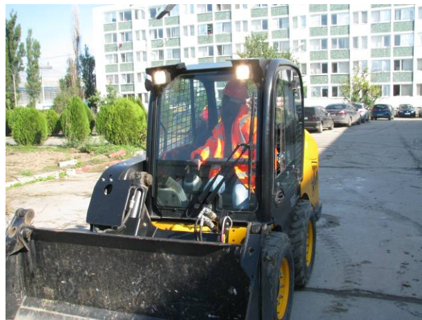
Miniîncărcător frontal JCB ROBOT 160 - lucrări practice
