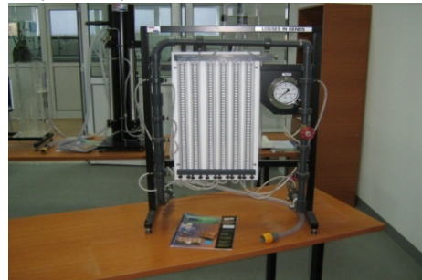
Instalație pentru determinarea pierderilor de sarcină locale
