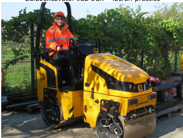
Cilindru vibrocompactor – lucrări practice
