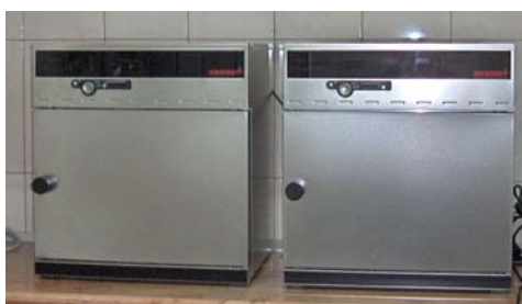
Etuvă Memmert 32 L și incubator termostaț Memmert 32 L
