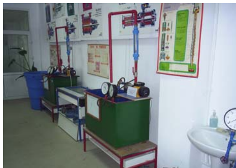
Instalație pentru studiul funcționării pompelor centrifuge cu ax orizontal
