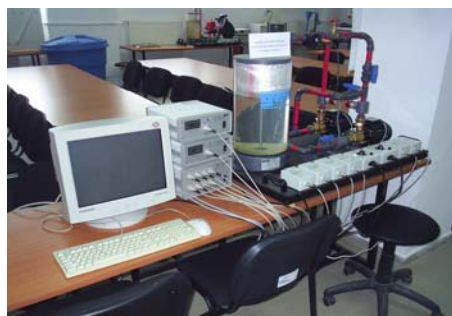
Instalație pentru studiul funcționării pompelor cuplate în serie și paralel
