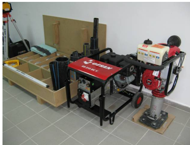
Grup electrogen pentru sudură și mai compactor
