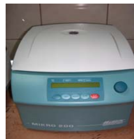
Centrifugă Eppendorf 15.000 rpm
