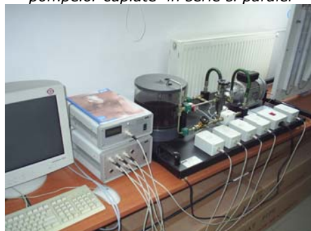
Instalație pentru studiul funcționării pompelor volumice cu roți dintate
