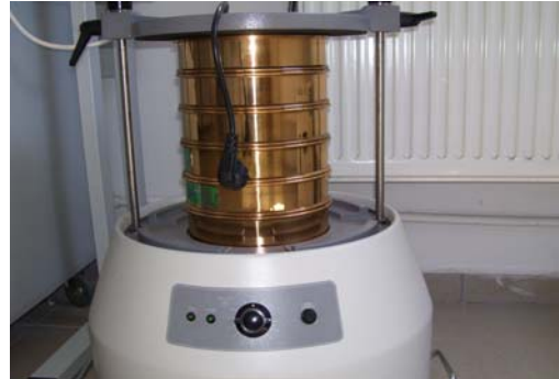
Set site pentru cernere cu acționare electrică
