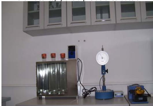
Baie cu temperatură constantă pentru determinarea granulozității prin metoda areometrului. Penetrometru cu con semiautomat; Aparat CASAGRANDE motorizat
