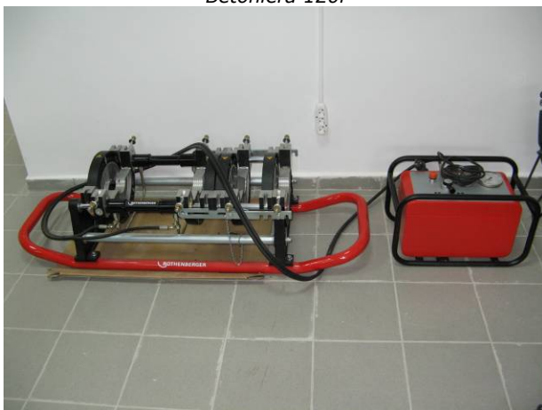
Aparat pentru sudura cap la cap a tuburilor PEID
