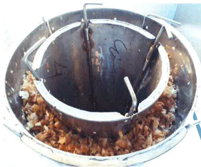
Fig. 2 Matriță confecționată din tablă de inox sub forma de vase concentrice, încărcate în spațiul delimitat de acestea, cu deșeurile lemnoase
