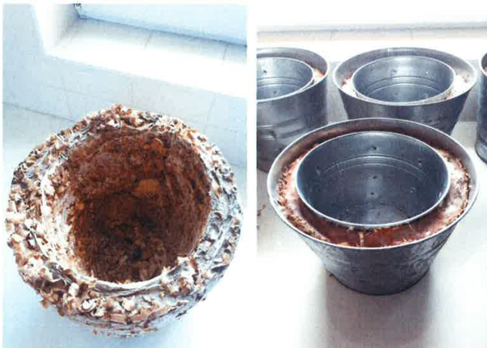
Fig. 7 – a) Suport biodegradabil destinat plantării speciilor vegetale, obținut prin cultivarea speciie Ganoderma lucidum pe substratul 1. b) Matrițe din tablă galvanizată în care s-au format suporturi biodegradabile prin cultivarea speciei Pleurotus ostreatus pe aceeași variantă de substrat
