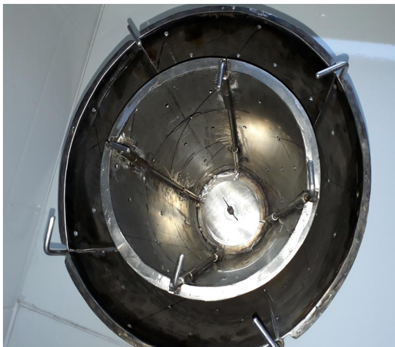
Fig. 2 a – Vas metalic confectionat din inox, care va fi utilizat ca matriță pentru forțarea creșterii miceliului de ciuperci din speciile Ganoderma lucidum și Pleurotus eryngii (vedere laterală)
