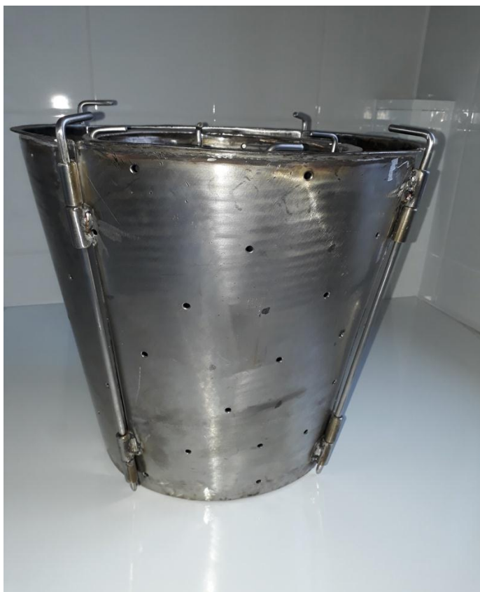
Fig. 2 a – Vas metalic confectionat din inox, care va fi utilizat ca matriță pentru forțarea creșterii miceliului de ciuperci din speciile Ganoderma lucidum și Pleurotus eryngii (vedere laterală)
