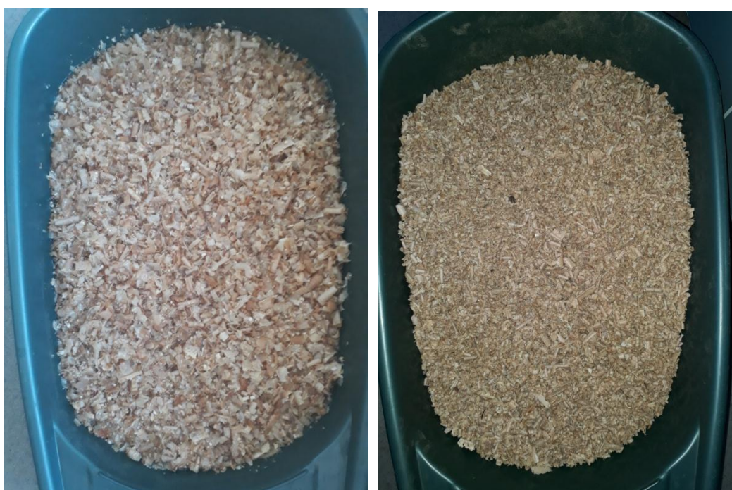
Fig. 3 – Deșeuri lemnoase sub formă de talaș în curs de hidratare a) lemn de tei; b) lemn de fag
