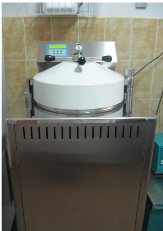
Fig. 4 - Autoclavă de laborator destinată sterilizării cu abur sub presiune a matrițelor ce conțin substraturile de cultivare a ciupercilor
